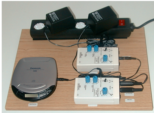
Abbildung 1a: Therapieeinheit mit Hochtontainer (bzw. Sprachwahrnehmungstrainer SWT) und Lateraltrainer (bzw. Raumwahrnehmungstrainer RWT) (Einzelgeräte mit Discman)
